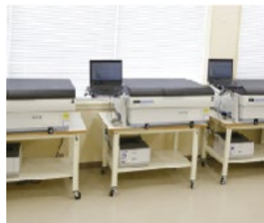
● 液体シンチレーションカウンタ
