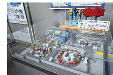
マイクロ波イオン源イオン注入装置、タンデム加速器、シンクロトロン3種類の加速器を組み合わせることで、幅広い分野の研究へ利用可能
